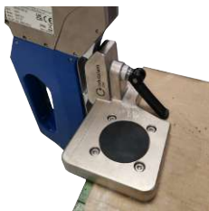
短时间存放时，垂直向下扳动快速夹紧器
