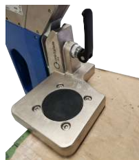
固定使用时，垂直向上扳动快速夹紧器。
