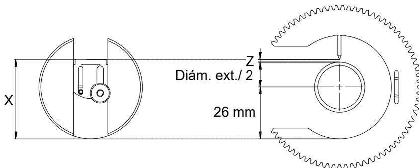
Fórmula para determinar la medida de ajuste X del medidor de ajuste de electrodo:
