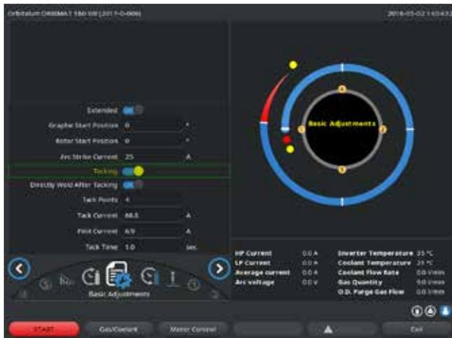
Fig. 21: Función de tacking
