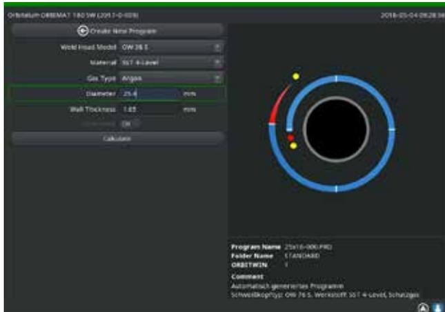
Fig. 10: Ajuste del diámetro de tubo
