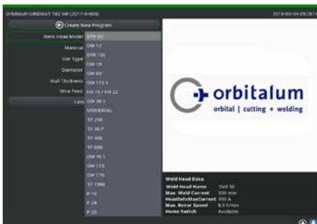
Fig. 8: Selección del cabezal de soldadura
