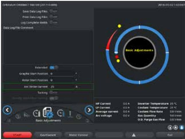
Fig. 16: Campo de entrada - Corriente de encendido y tiempo de retraso en el arranque del motor
