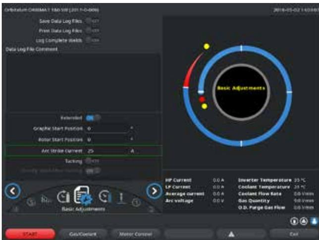
Fig. 16: Champ d'introduction – Courant d'amorçage et temps d'amorçage
