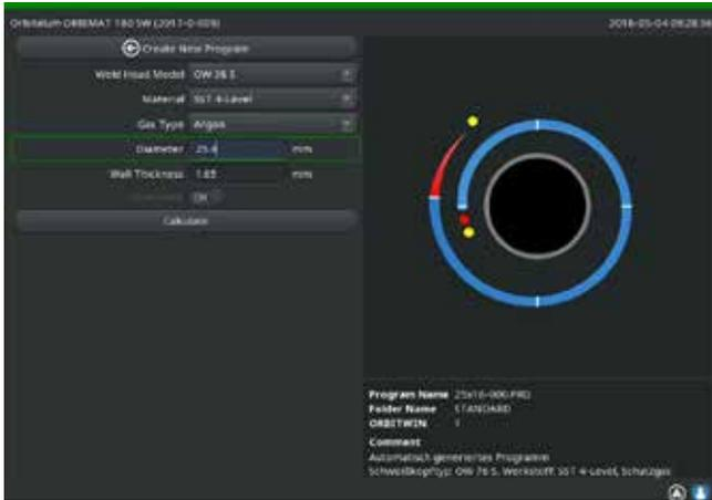
Fig. 10: Réglage du diamètre de tube
