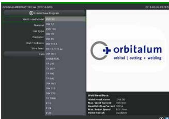
Fig. 8: Sélection de la tête de soudage
