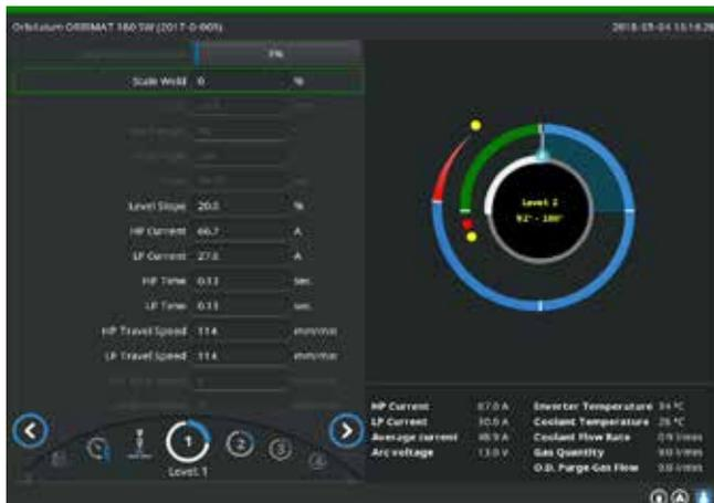
Fig. 13: Affichage dans le processus de soudage en cours
