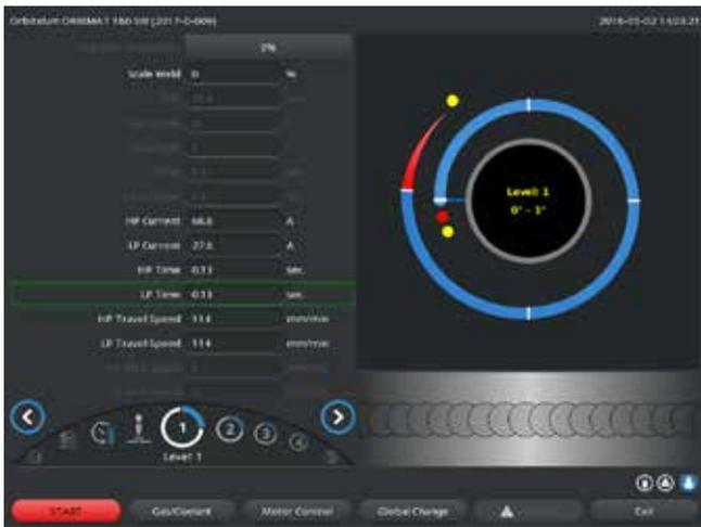
Fig. 18: Champ d'introduction d'un secteur avec représentation des écailles de cordon de soudure.
