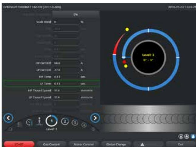
Fig. 18: Campo di immissione di un settore con rappresentazione della costolatura della saldatura
