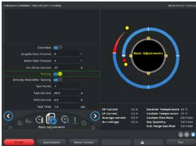
Fig. 21: Funzione di puntatura
