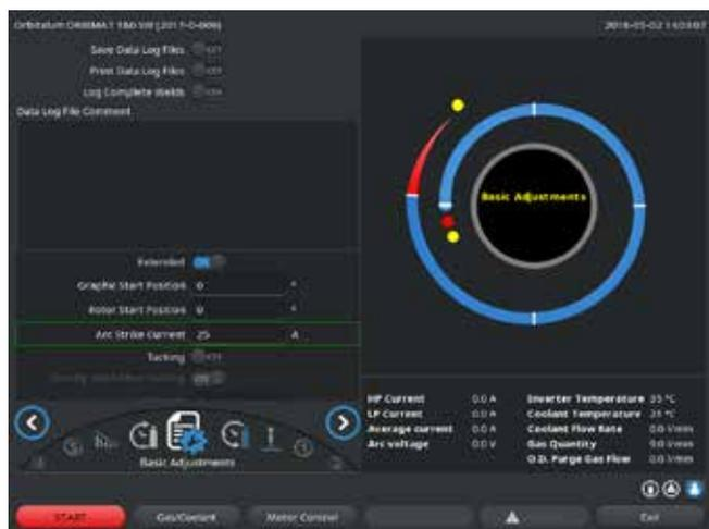
Fig. 16: Campo di immissione – Corrente di innesco e tempo di formazione del bagno
