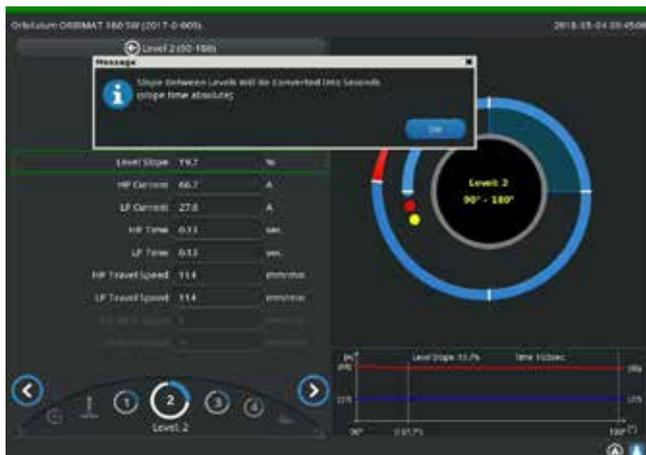
Fig. 17: Conversione del tempo di rampa da percentuale a secondi
