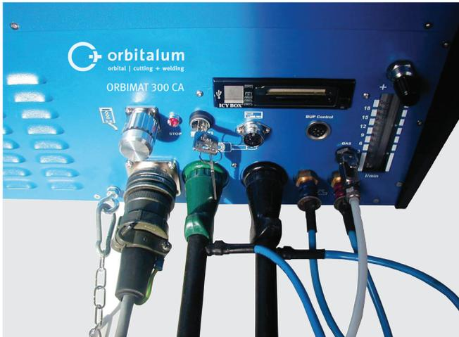
Abb. 4: Schweißkopf, angeschlossen
