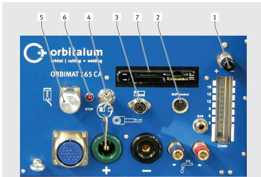
Fig. 3: Plaque frontale : raccords et éléments de commande
