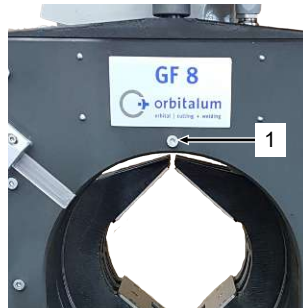
Posición del tornillo de bloqueo (1) en la GF 8, GF 12 (AVM/MVM).
