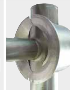
Dispositifs de serrage en T avec possibilité de recevoir le tube rétréci et le tube à souder
