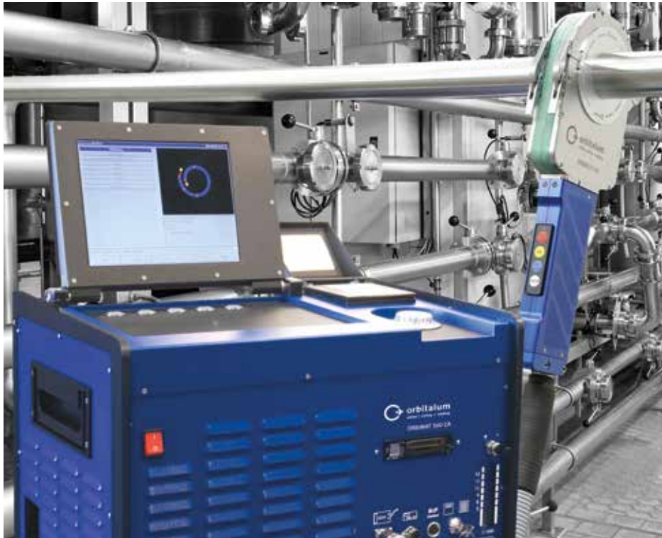
Moniteur orientable de 10,5" et imprimante système intégrée
