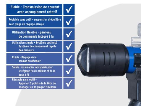
La tête de soudage TIG tube dans le sol P16 EV0 est le résultat d'un développement continu de la série P éprouvée. L'équilibrage sans outil et lepanneau de commande intégré augmentent le confort d'utilisation. L'utilisation de composants et de matériaux de haute qualité élève la reproductibilité précise des soudures à un niveau supérieur.
