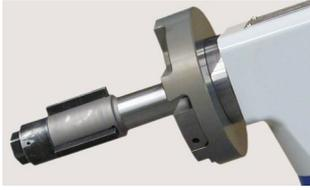
El nuevo sistema de sujeción "NC", con sus cuñas de sujeción firmemente ancladas en el mástil, es ideal para aplicaciones en las que debe impedirse la caída de cuerpos extraños en el interior de tubos o en un depósito. Especialmente a la hora de realizar trabajos verticales, el sistema de sujeción "NC" aporta una seguridad adicional. Las cuñas de sujeción se intercambian rápidamente.
