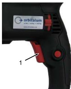
电子驱动规格的开/关按钮
