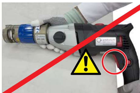
Obr.: Tlačítko ZAP/VYP stlačené o pracovní stůl
