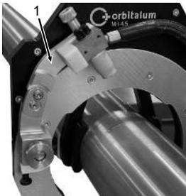
Abb.: Brennergelenkarm in Grundposition
