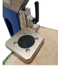
*Dispositif de serrage rapide rabattu verticalement vers le bas pour le dépôt bref*
