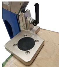
クイックリリースを下に倒すと、一時的に格納で クイックリリースを上に戻すと固定できます。
