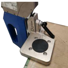
Snelspanner verticaal omlaag geklapt voor kortstondig vasthouden
