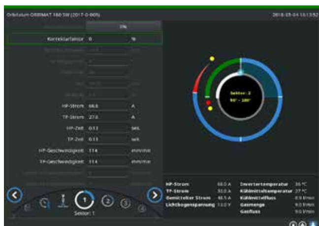
Sl. 13: Prikaz v tekočem varilnem procesu
