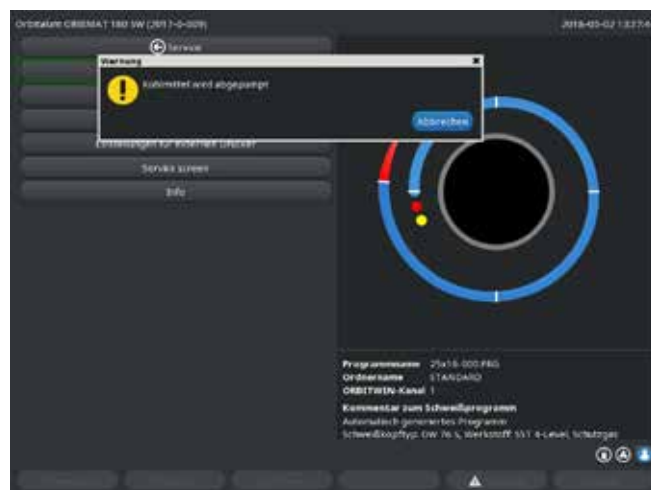
Sl. 4: Izčrpavanje hladilnega sredstva
