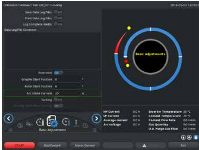
Obr. 16: Zadávací pole – Zapalovací proud a čas tvoření lázně
