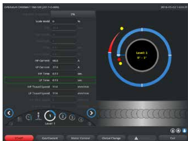
Obr. 18: Zadávací pole jednoho sektoru se zobrazením šupinatosti tvaru svaru
