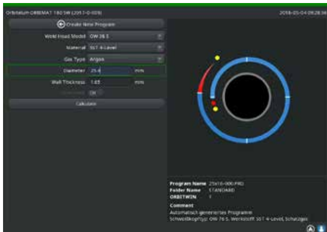
Obr. 10: Nastavení průměru trubky
