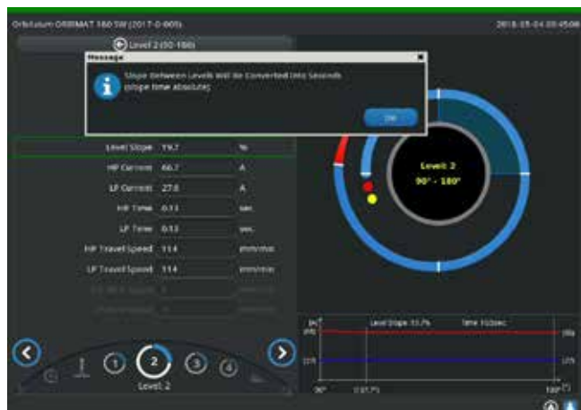
Abb. 13: Conversione del tempo di rampa da percentuale a secondi
