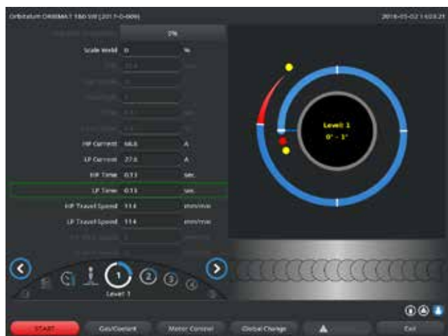
Abb. 14: Campo di immissione di un settore con rappresentazione della costolatura della saldatura
