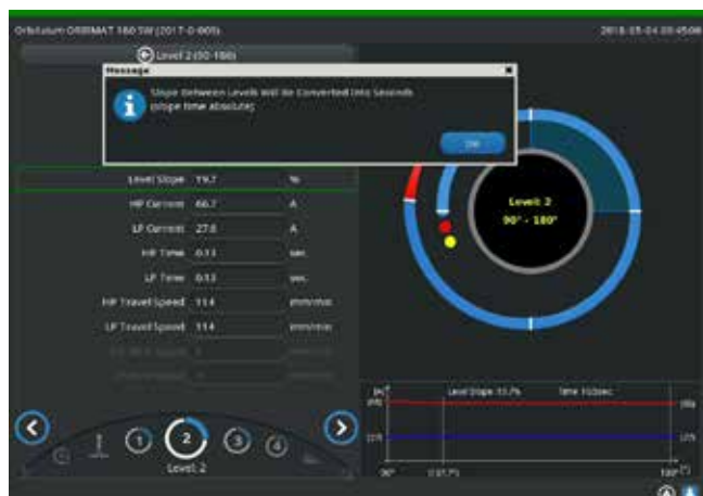
Abb. 13: Conversion du temps de pente de pourcentage en secondes
