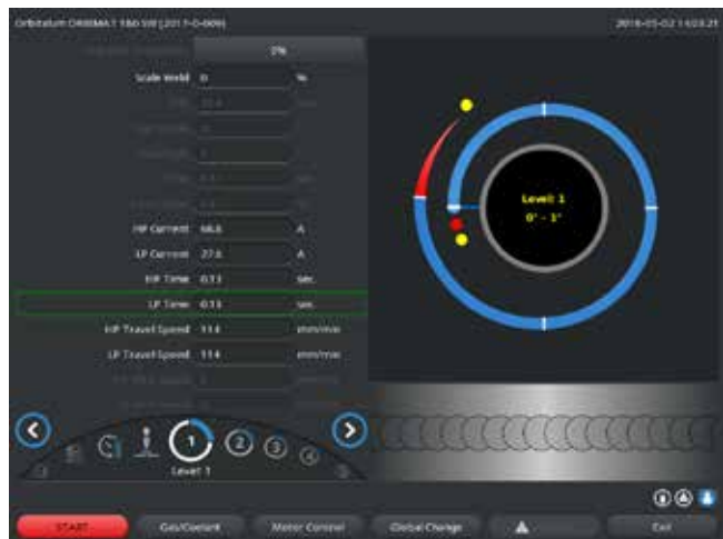
Abb. 14: Zadávací pole jednoho sektoru se zobrazením šupinatosti tvaru svaru
