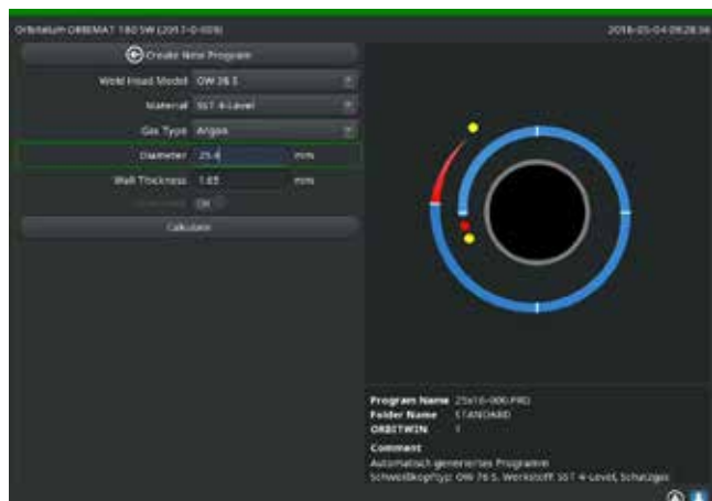
Abb. 6: Impostazione diametro del tubo
