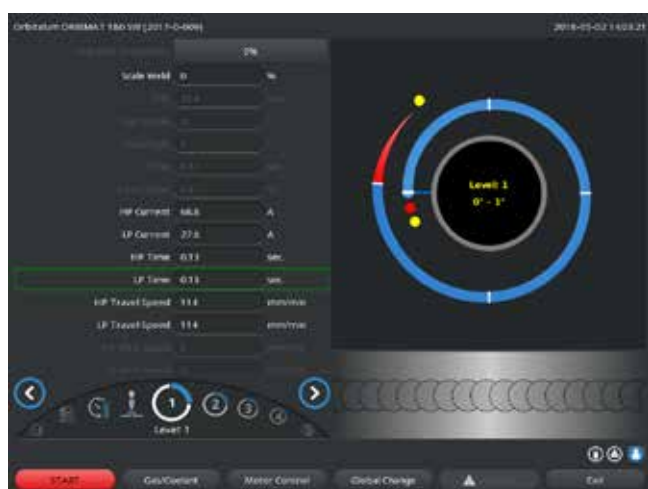
Abb. 14: Campo de entrada de un sector con representación de la descamación de la costura
