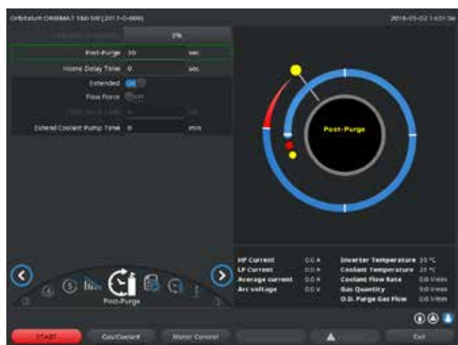
Abb. 11: Campo de entrada – Tiempo después de la purga del gas
