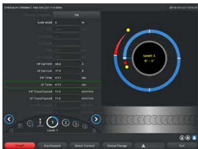
Abb. 14: Champ d'introduction d'un secteur avec représentation des écailles de cordon de soudure.
