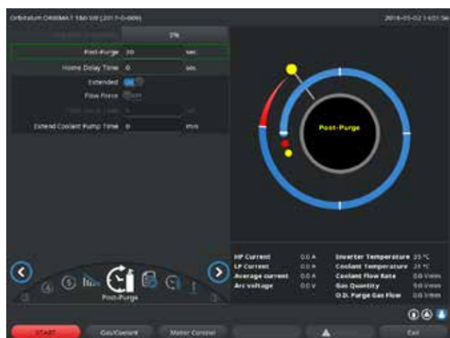
Abb. 11: Campo di immissione – Tempo di flusso finale del gas
