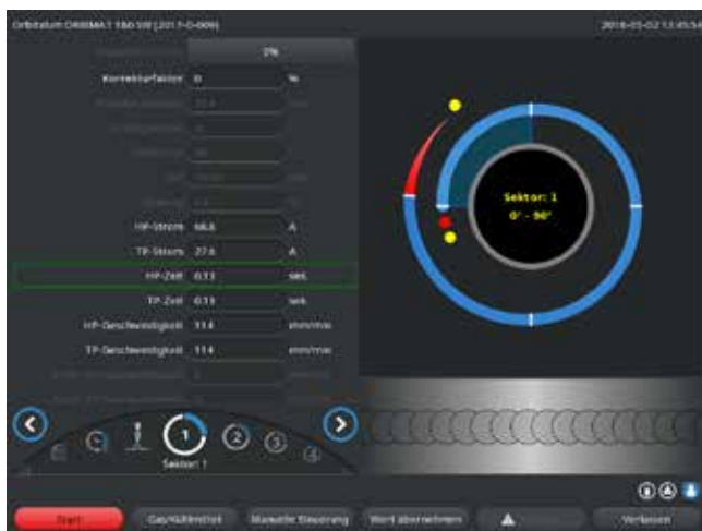
Abb. 14: Eingabefeld eines Sektors mit Darstellung der Nahtschuppung
