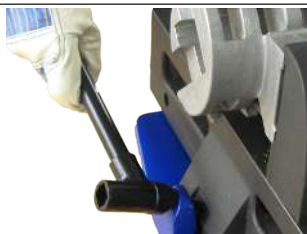
钢管锯固定在快速安装板上
