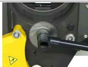
Upevnění pilového listu/frézy
