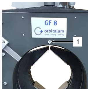
Poloha pojistného šroubu (1) u GF 8, GF 12 (AVM/MVM).
