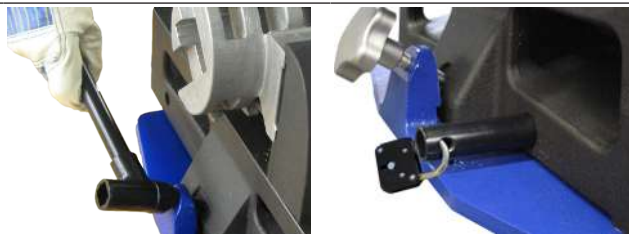
Befestigung der Säge auf der Säge- Verriegelung des Drehkörpers ge auf der Schnellmontageplatte schützt vor unerlaubter Benut- zung und Diebstahl.
