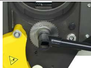
Fissaggio della lama/fresa
