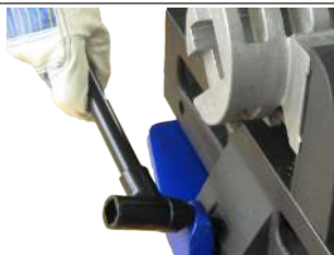
Bevestiging van de zaag op de snelmontageplaat
