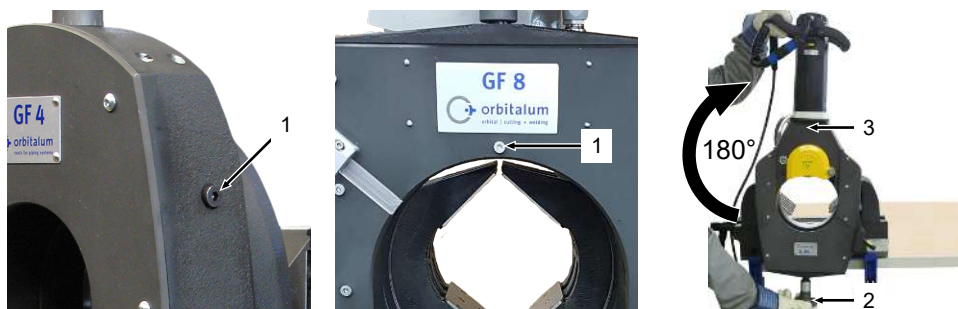
Posição do parafuso de bloqueio (1) na GF 4 e GF 6 (AVM/MVM). Posição do parafuso de bloqueio (1) na GF 8 e GF 12 (AVM/MVM).
