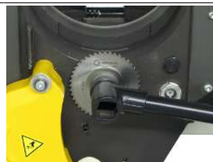
Upevnenie pílového kotúča/frézy
