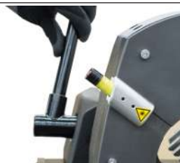
Upevnenie upínacích čelustí (len pri GF 4 (AVM/MVM))
