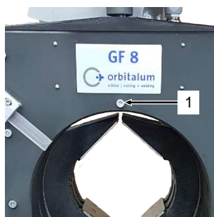
Poloha poistnej skrutky (1) pri GF 8, GF 12 (AVM/MVM).
