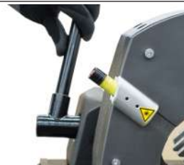
Pritrditev vpenjalnih čeljusti (samo pri GF 4 (AVM/MVM))
