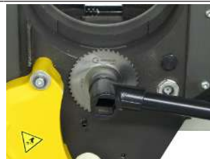
Pritrditev žaginega lista/ rezkalnika
