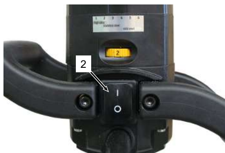
Prekucno stiklo za VKLOP/IZKLOP na motorju
