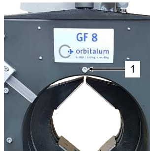
Položaj zaklepne vijaka (1) pri GF 8, GF 12 (AVM/MVM).
