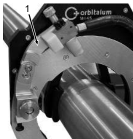
Fig.: brazo articulado del soplete en posición inicial
