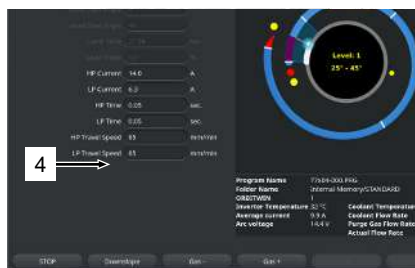
Fig. : Position de la torche et de départ du programme de soudage en position à 9 heures
