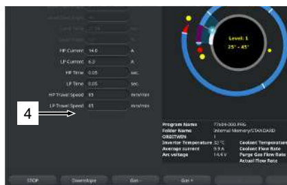
Fig.: posizione torcia e posizione iniziale programma di saldatura in posizione "ore 9"
