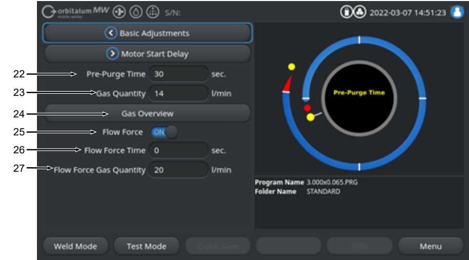
圖: “Gas Pre-Purge”（前吹气）焊接方案部分
