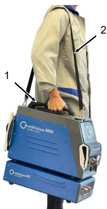
Fig.: Transporte de Mobile Welder
