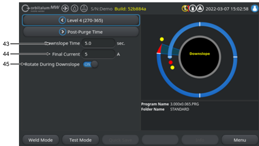
Fig.: Section de programme de soudage « Downslope » (Fin de la soudure)
