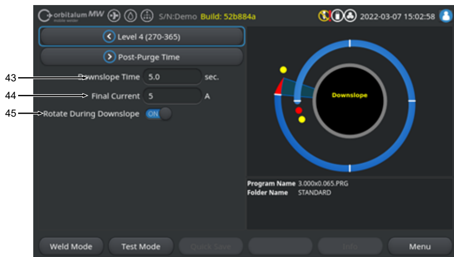
Abb.: Sezione "Downslope" (Evanescenza) del programma di saldatura
