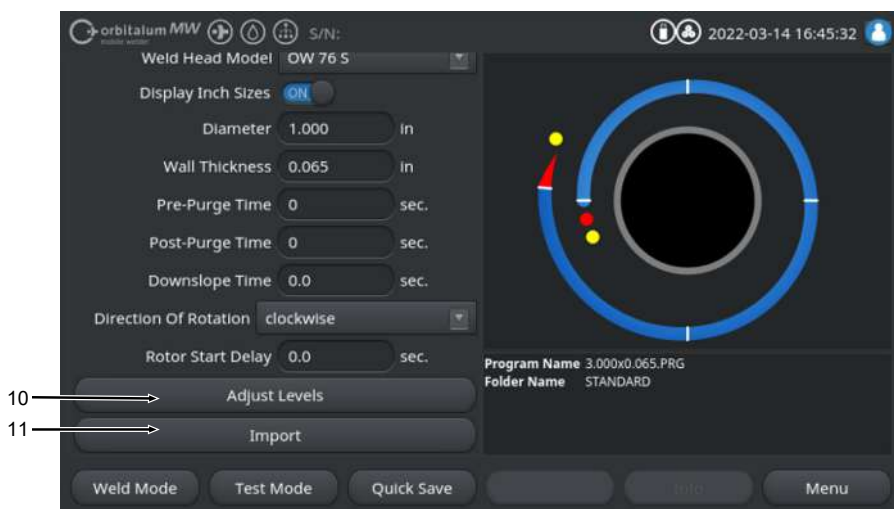
Abb.: Menu "Procedure Import" (Importa procedura), area inferiore
