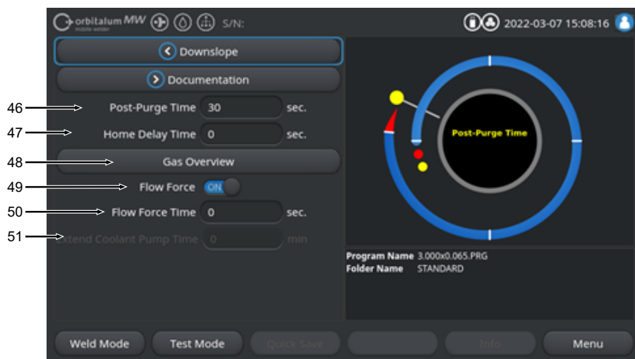
Abb.: Sezione "Gas Post-Purge" (Post-Gas) del programma di saldatura
