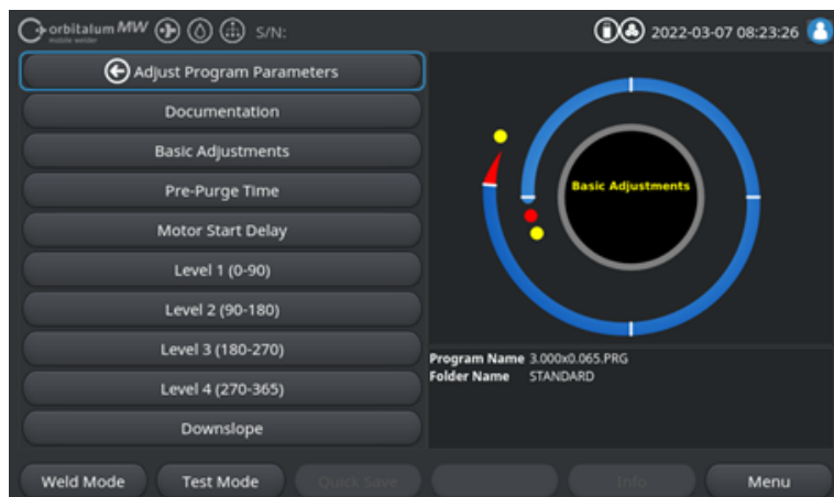
Abb.: Menu "Adjust Program Parameters" (Gestisci parametri)
