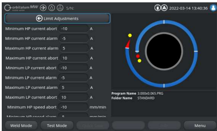
Abb.: Menu "Limit Adjustments" (Limiti parametri)
