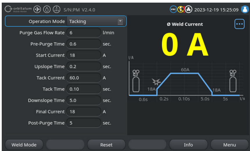
Abb.: Programmazione manuale, modalità di funzionamento Puntatura
