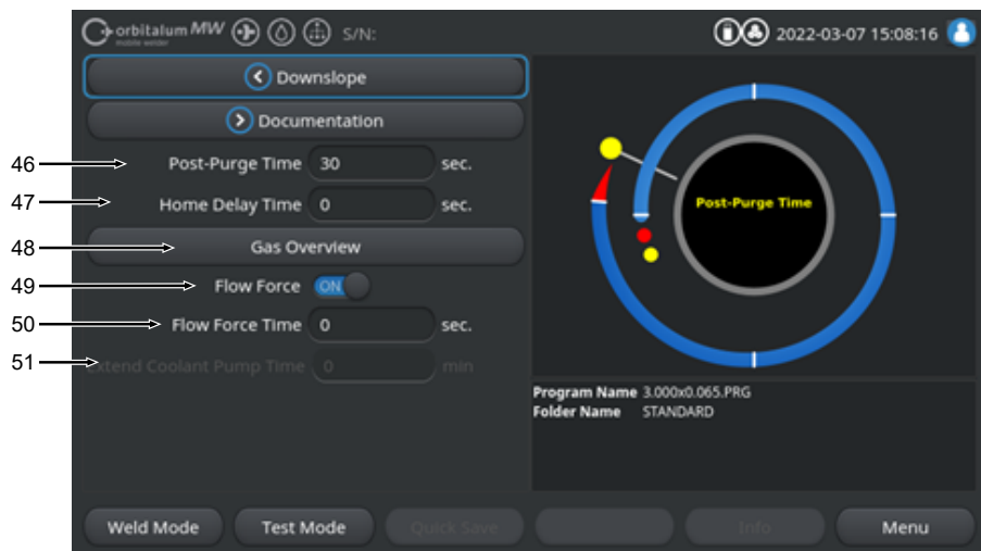
Fig.: "Sectie Gas Post-Purge" (Gas nastroom) van het lasprogramma
