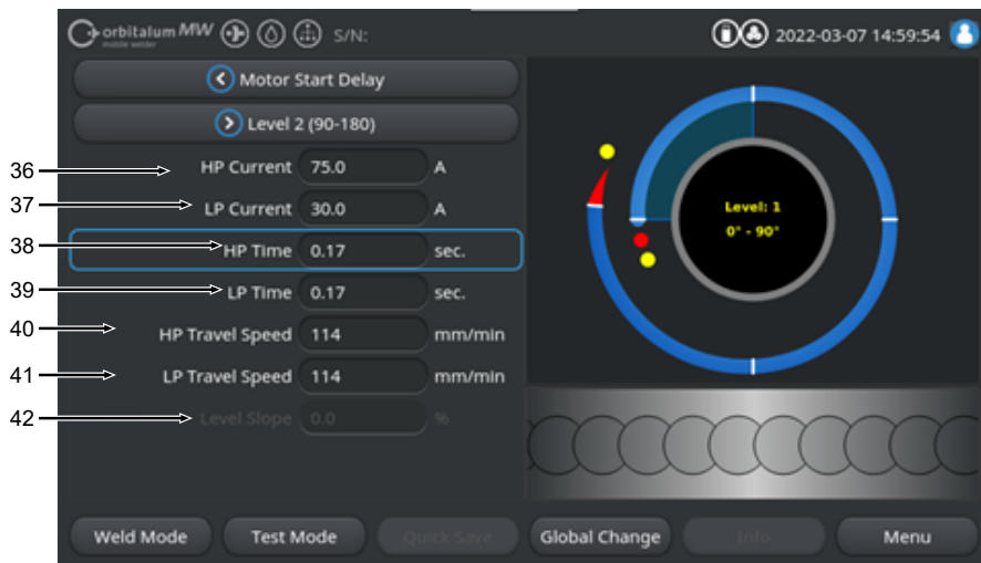
Rys.: Sekcja programu spawania „Sektor”
