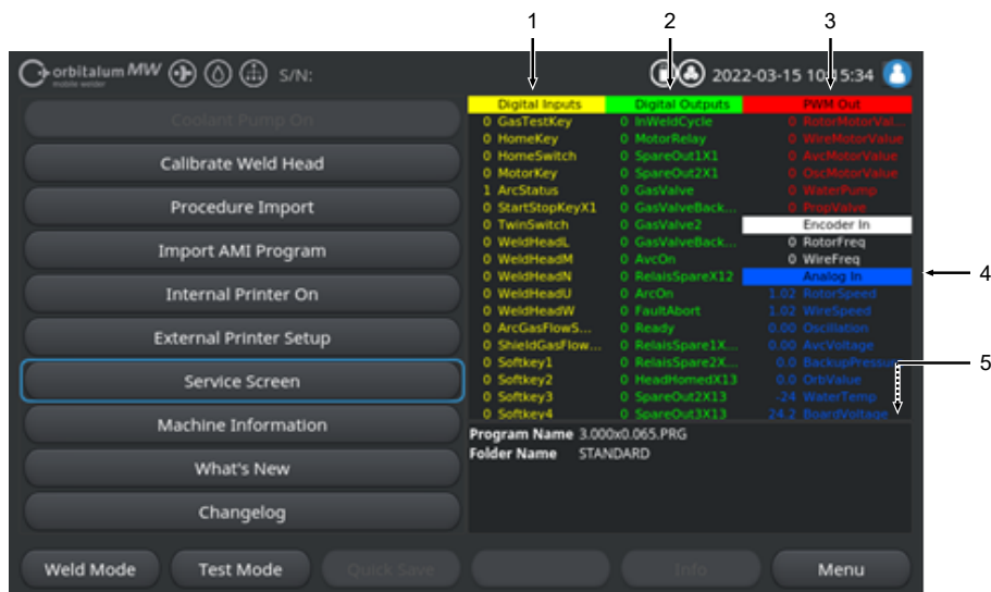
Rys.: Menu "Service screen", tabela wartości sygnałów, obszar górny
