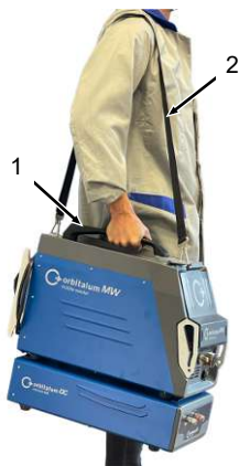
Rys.: Transport urządzenia Mobile Welder
