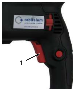
Pulsante ON/OFF variante elettrica
