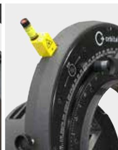
Puntatore laser integrato per l'individuazione del punto di taglio sul tubo
