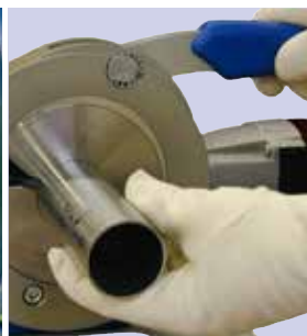
Sistema di cambio rapido per utensili, ganasce di serraggio e tubi
