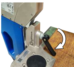
Dispositif de serrage rapide rabattu verticalement vers le bas pour pose temporaire
