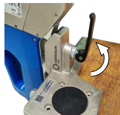
Dispositif de serrage rapide rabattu verticalement vers le haut pour l'utilisation fixe.
