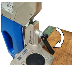
Leva di serraggio rapido in posizione verticale verso il basso per l'alloggiamento temporaneo
