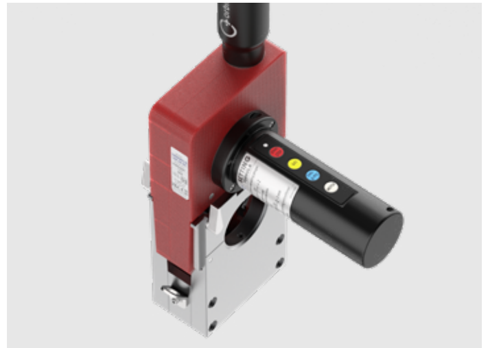
Panneau de commande intégré - toutes les commandes importantes pour le soudage peuvent ainsi être transmises à la source de courant, de sorte qu'aucune télécommande supplémentaire n'est nécessaire.
