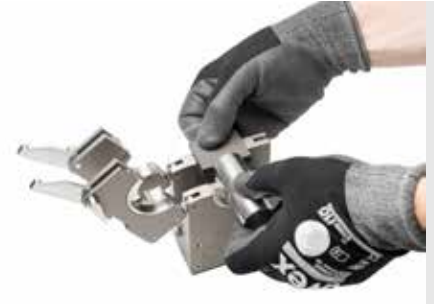
Un gabarit de centrage de tube, fixé à la cassette de serrage et donc imperdable, assure le positionnement exact du joint de tube à souder.
