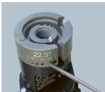
Affûtage des électrodes: 4 angles différents, 6 diamètres d'électrodes différents
