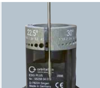
Coupure à longueur des électrodes
