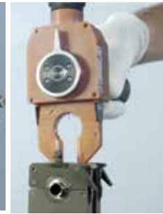
Cassette de serrage amovible, idéale pour la fabrication en ligne sur le chantier ou pour la production de modules préfabriqués dans l'atelier.
