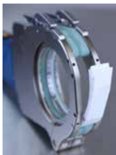
Copertura apribile della testa di saldatura "FlipCover"
