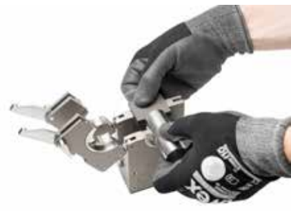
Un calibro di centratura del tubo montato sulla cassetta di serraggio assicura l'esatto posizionamento del giunto da saldare.
