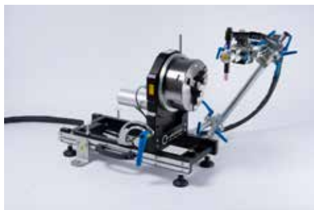
DVR M impostato per saldature orizzontali
