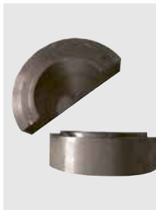
Collari a camera per la saldatura di parti sagomate
