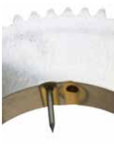
Montaggio più facile degli elettrodi grazie ai segni per Ø 1,0/1,6 mm (0.039"/0.063")
