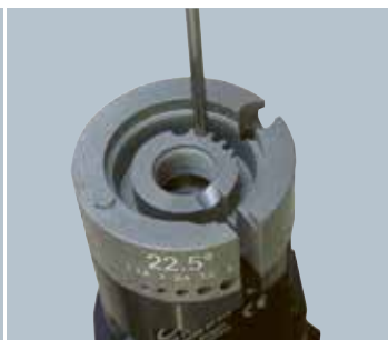
Intestatura della punta di elettrodi
