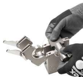
Fig.: Un gabarit central fixé à la cassette de serrage et donc imperdable garantit le positionnement exact du joint à souder.
