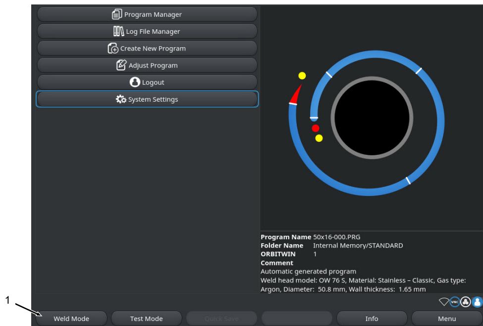
Fig.: Menú principal, Softkey «Soldadura»
