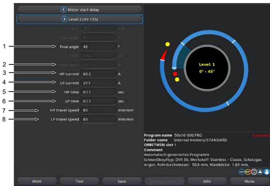
图: 焊接程序部分“扇区”
