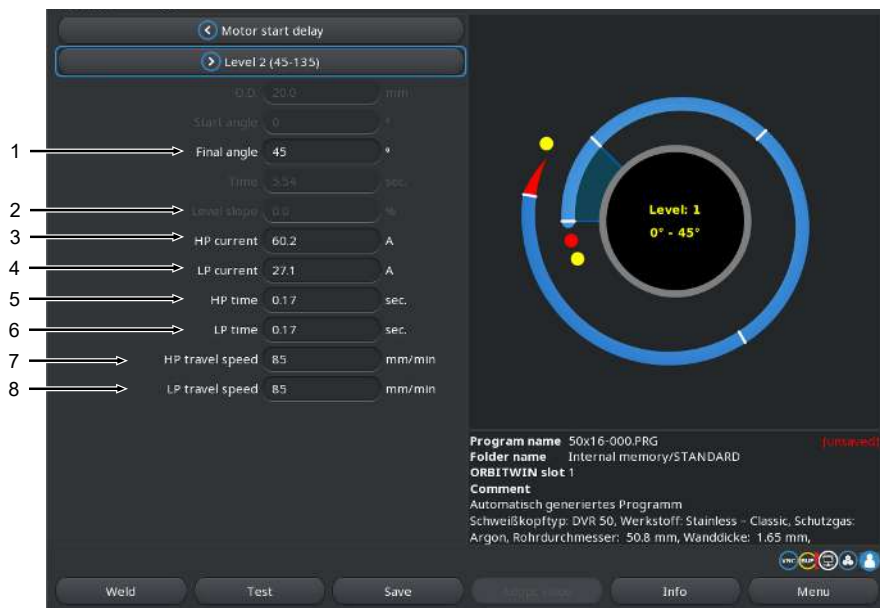
Fig.: Sección del programa de soldadura «Sector»
