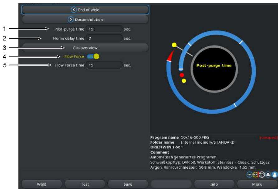
Fig.: Sección del programa de soldadura «Tiempo de posgasificación»
