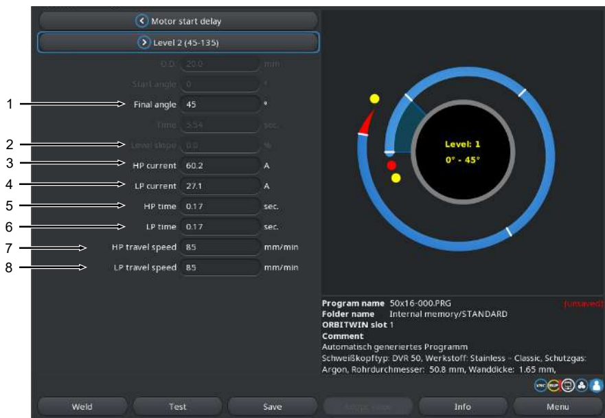
図: 溶接プログラムセクション「セクター」
