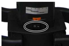
Interruptor basculante de ligar/desligar no motor
